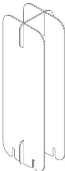
Рис. 3.2 Воздушный диффузор малый
