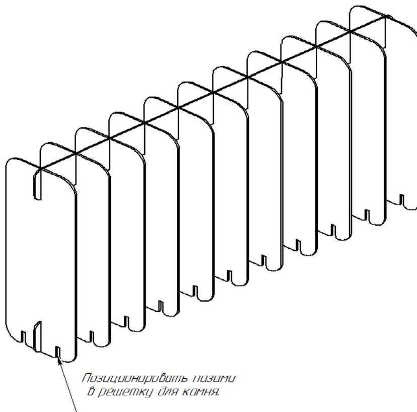
Рис. 3.1 Воздушный диффузор большой.
